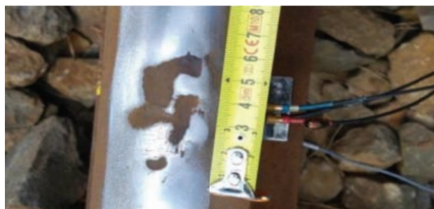
Rys. 3. Przykład wady „zagłębienia” [16]
