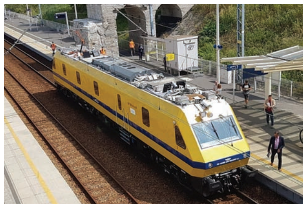
Rys. 5. Kolejowa drezyna pomiarowa [3]
