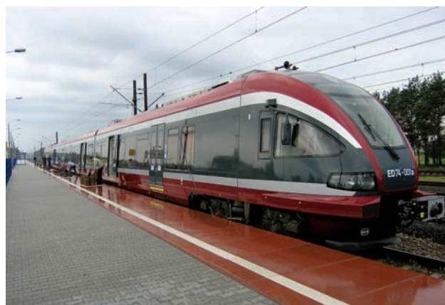
Fig. 6. ED74 electric multiple unit during preparations for dynamic brake testing – Włoszczowa Północ station on the Central Rail Line, 2007 [photo: P. Urbańczyk]
