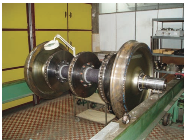
Rys. 3. Zestaw kołowy podczas przygotowywania instalacji do pomiaru sił QY [fot. A. Zbieć]
