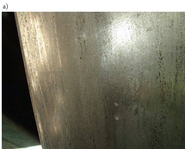
Rys. 17. (a) Powierzchnia toczna koła współpracującego z wstawką żeliwną ( R_a = 2,11 \mu\text{m} ), b) powierzchnia koła współpracującego z wstawką kompozytową typu K ( R_a = 0,47 \mu\text{m} ) [fot. P. Tokaj]
