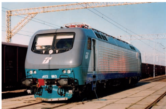
Rys. 5. Lokomotywa elektryczna typu E412 dla włoskich kolei Ferrovie dello Stato Italiane (FS) podczas badań hamulca prowadzonych przez Pracownię Hamulców z Krakowa – Tor Doświadczalny CNTK, 1998 [fot. P. Urbańczyk]
