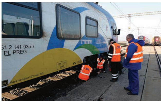
Rys. 8. Krakowscy specjaliści podczas badań ezt 36WEa wyposażonego w innowacyjny system aktywnej regulacji opóźnienia hamowania (DCC) – Tor Doświadczalny IK, 2018 [fot. P. Urbańczyk]
