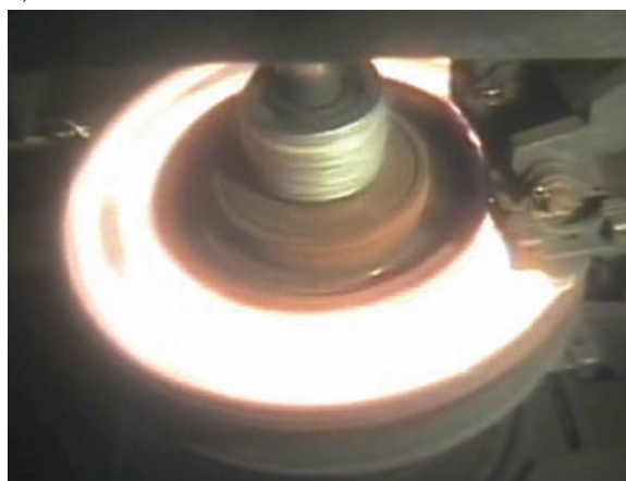
Rys. 11. Widok pierścieni ciepłych podczas badań sprawdzających odporność na obciążenia termiczne: (a) tarczy montowanej na osi; (b) koła monoblokowego [zbiory archiwalne IK]
