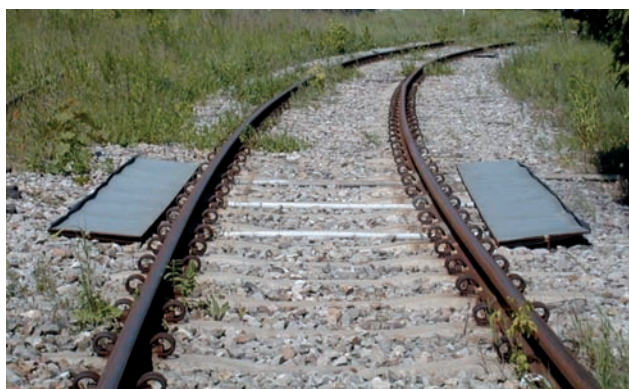
Rys. 12. Łuk pomiarowy zbudowany zgodnie z normą PN-EN 14363 [12] metoda 1 [fot. A. Chojnacki]
