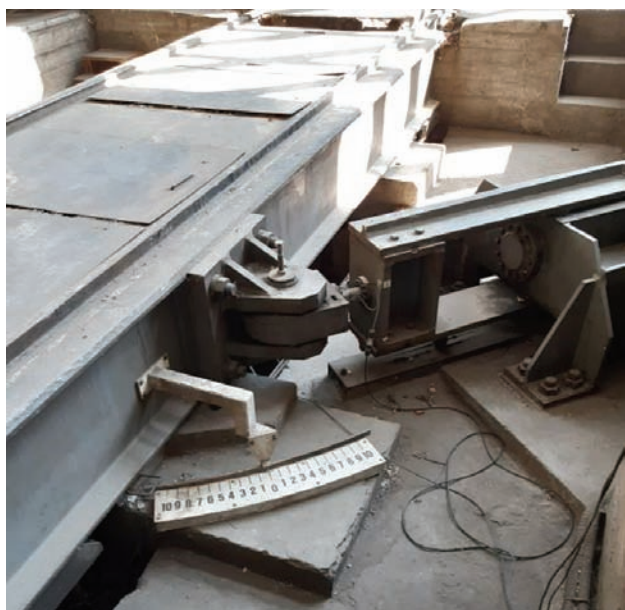
Rys. 15. Stanowisko IK do pomiaru momentu oporowego wózków względem nadwozia [fot. A. Chojnacki]
