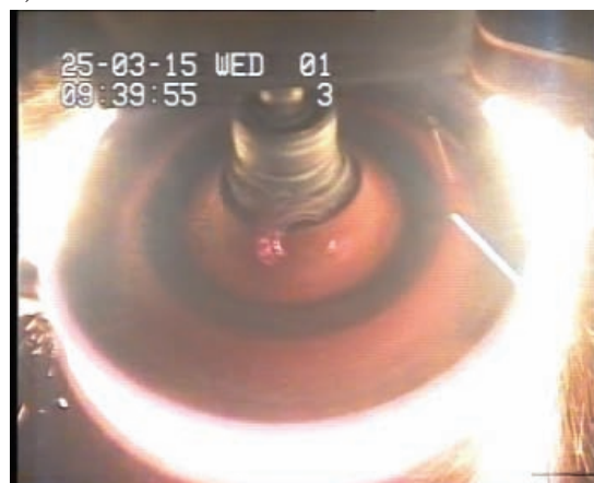
Rys. 11. Widok pierścieni ciepłych podczas badań sprawdzających odporność na obciążenia termiczne: (a) tarczy montowanej na osi; (b) koła monoblokowego [zbiory archiwalne IK]
