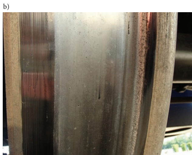
Rys. 17. (a) Powierzchnia toczna koła współpracującego z wstawką żeliwną ( R_a = 2,11 \mu\text{m} ), b) powierzchnia koła współpracującego z wstawką kompozytową typu K ( R_a = 0,47 \mu\text{m} ) [fot. P. Tokaj]
