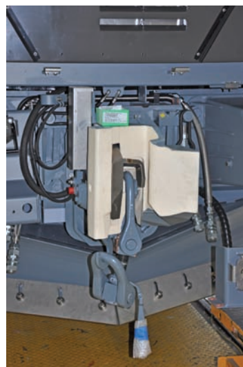
Rys. 24. Sprzęg mieszany LAF (UIC + SA-3) w lokomotywie Vectron VR [fot. M. Graff]
