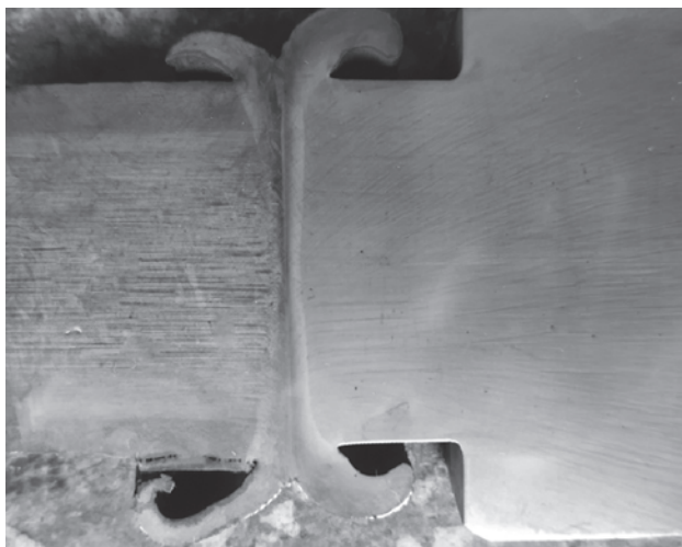
Rys. 3. Makrografia zgrzeiny wykonanej tarczywo. Trawienie wykonano odczynnikami Adlera zgodnie z wycofaną normą PN-61/H-04502 [4] [fot. M. Ostromęcka]
