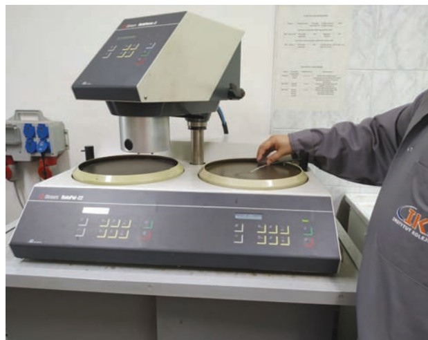
Rys. 2. Szlifowanie na szlifierko-polerce RotoPol-22 formy Struers w Laboratorium Badań Materiałów i Elementów Konstrukcji Instytutu Kolejnictwa [fot. M. Ostromęcka]
