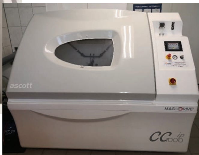
Rys. 3. Stanowisko badawcze do starzenia próbek według PN-EN ISO 9227 [12] (komora solna Ascott CC1000IP) [fot. M. Garbacz]
