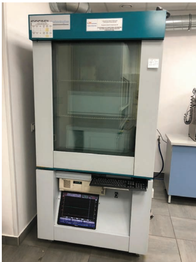
Rys. 2. Stanowisko badawcze do starzenia próbek według DN 001/08/A2/16 [10] (komora klimatyczna SECASI SI550C150F40H oraz lampa Famed-1 typ L8/59) [fot. M. Garbacz]
