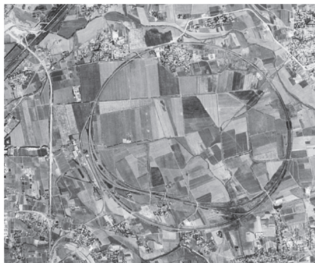
Rys. 6. Zdjęcie satelitarne okręgu doświadczalnego CARS pod Pekinem [1967 rok]
