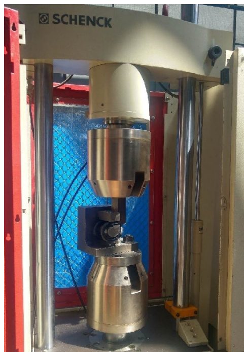
Rys. 3. Widok maszyny wytrzymałościowej Sinus 250 z oprzyrządowaniem do badania siły docisku łapek sprężystych SB4 [fot. autorzy]
