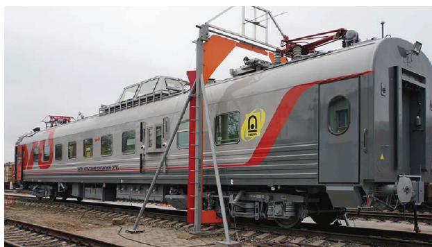
Rys. 5. Wagon Integral na stanowisku kalibracji przyrządów pomiarowych [19]
