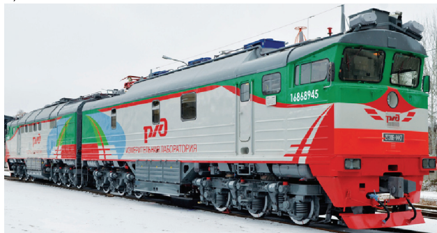
Rys. 10. Spalinowa lokomotywa pomiarowa SMDL-2TE116 [6]; a) widok lokomotywy, b) urządzenia do laserowego monitorowania stanu szyn, c) georadar do monitorowania podtorza, d) urządzenia do monitorowania stanu sieci trakcyjnej
