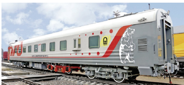
Rys. 6. Wagon defektoskopowy VD-UMT-2 przeznaczony do kompleksowej diagnostyki obiektów infrastruktury kolejowej z wykorzystaniem ultradźwiękowych, magnetycznych i optycznych metod badań nieniszczących [17]
