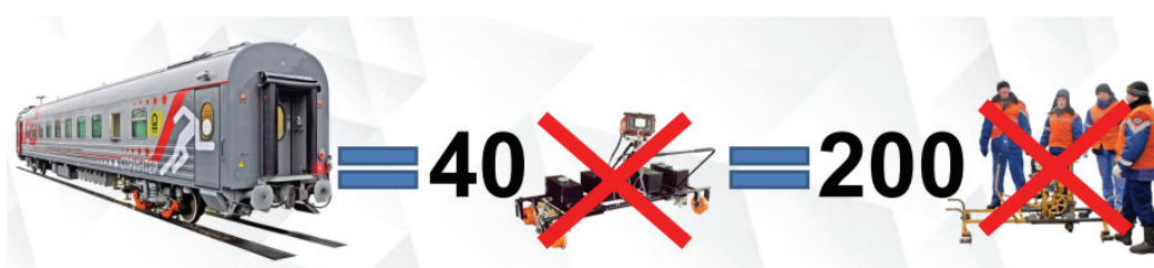
Rys. 15. Jeden wagon defektoskopowy eliminuje 40 urządzeń obsługiwanych ręcznie i 200 pracowników niezbędnych do ich obsługi [11]
