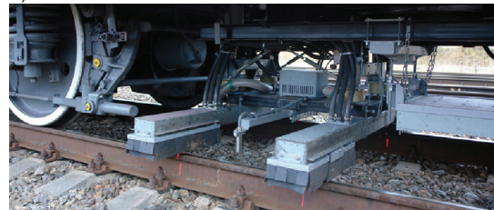
Rys. 11. Elektryczna lokomotywa pomiarowa SPL-CzS200 (a), zminiaturyzowane urządzenie laserowe do pomiaru stanu szyn (b) [7]
