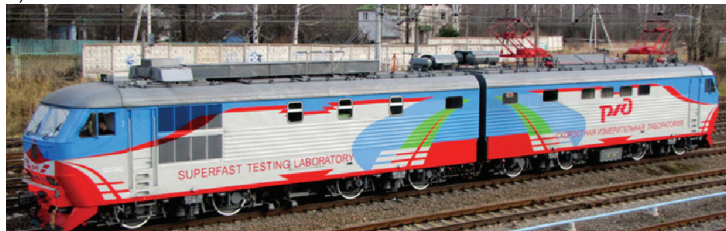
Rys. 11. Elektryczna lokomotywa pomiarowa SPL-CzS200 (a), zminiaturyzowane urządzenie laserowe do pomiaru stanu szyn (b) [7]
