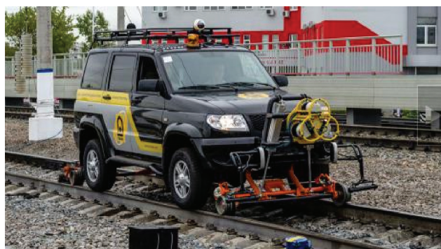
Rys. 14. Pojazd drogowy wykorzystywany do pomiarów infrastruktury torowej [12]
