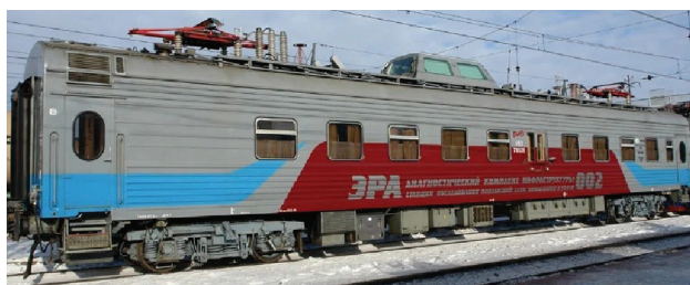
Rys. 4. Wagon ERA do badania sieci trakcyjnej, urządzeń automatyki i telemechaniki [14]
