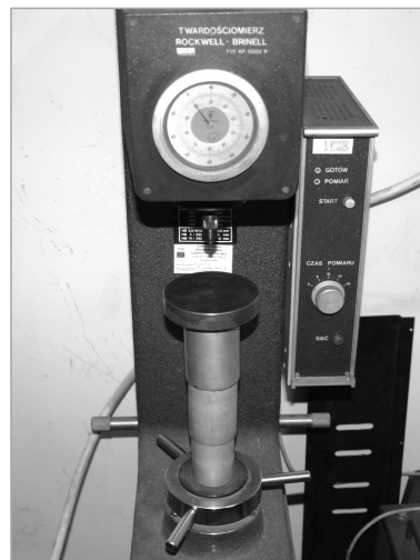
Fig. 3. Hardness tester KP15002 P [photo. K. Franczak]
